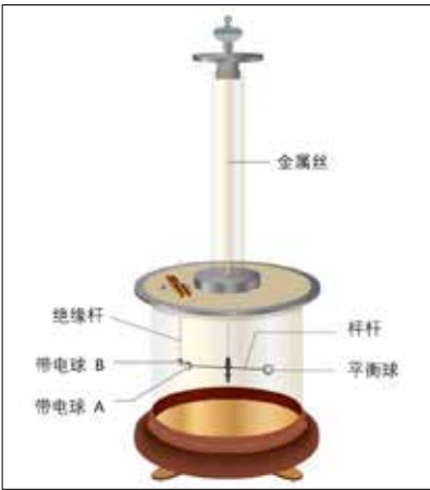
图4 库仑扭秤的结构
