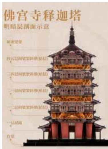
图 10 应县木塔暗层示意图 (来源: 网络)
