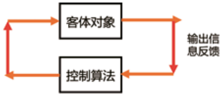
图6 对象的物理因果链和反馈的逻辑因果链组成了闭环控制系统
