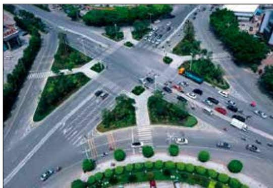
图 5 十字路口行驶车道与逆向车道数之比为 4:2 (图片来源于网络)
