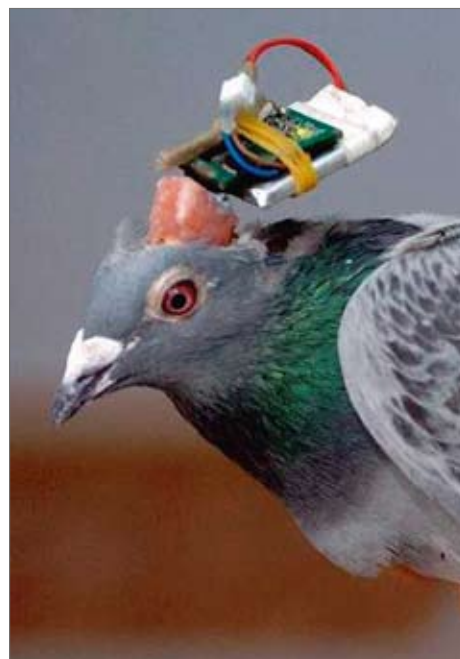
图26 由“王冠”固定接口的帅搏格鸽及收音机、电源等微型设备
