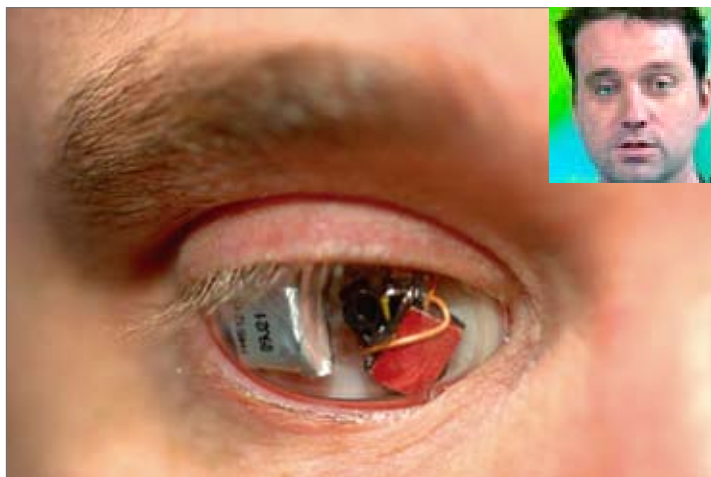
图5 罗伯·斯宾斯含有摄像仪及无线发信机的假眼
