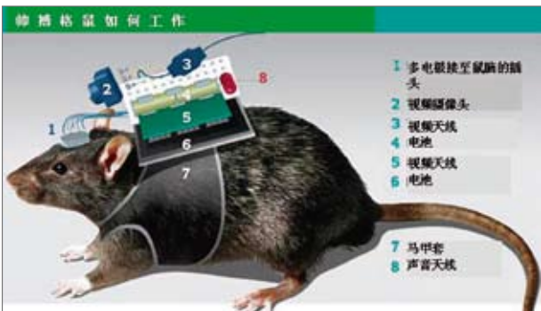
图19 被植入电极远程控制的老鼠，背有多种微电子装置
