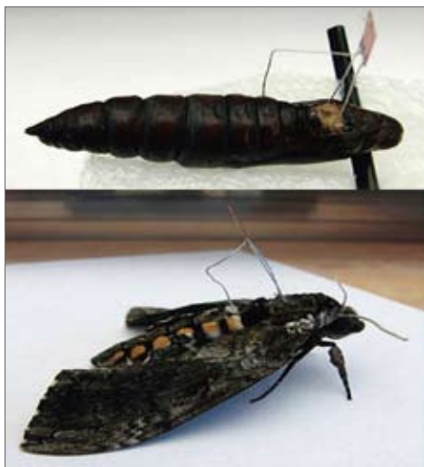
图23 电极植入飞蛾蛹(上),下为成虫
