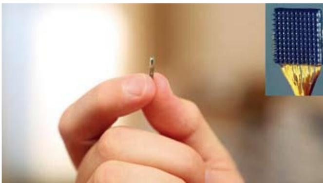
图6 装入小玻璃管内的芯片（右上为放大图）及电磁线圈
