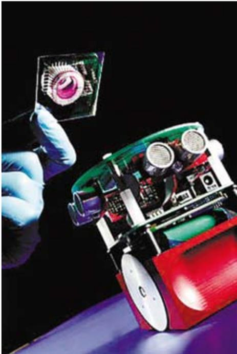
图19 帅搏格脑控制移动机器人，左上为制备生物脑用的多电极矩阵
