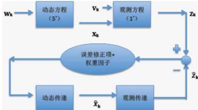
图1 卡尔曼滤波器方框图
