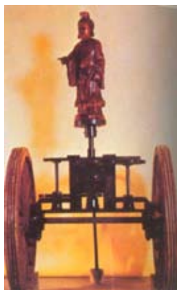
图1 指南车复原模型
